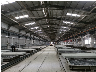
預製混凝土構件固定式生產線
