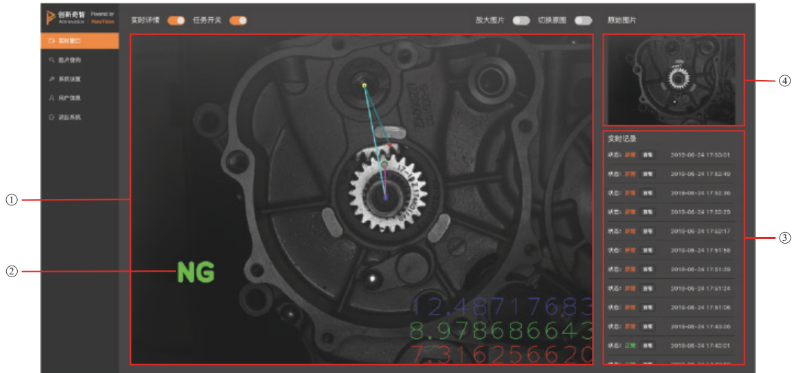
正時點不一致時於生產線檢測出的缺陷
