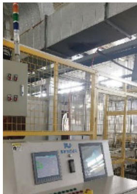
離鈹機及擠型機安全防護升級， 電氣主控系統置於外側， 大幅降低操控和編程時風險
