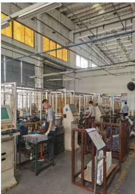
單、雙彎機及沖壓機等的 電氣控制部分移至防護欄外側， 大幅降低電氣控制系統於 檢測維修時風險
