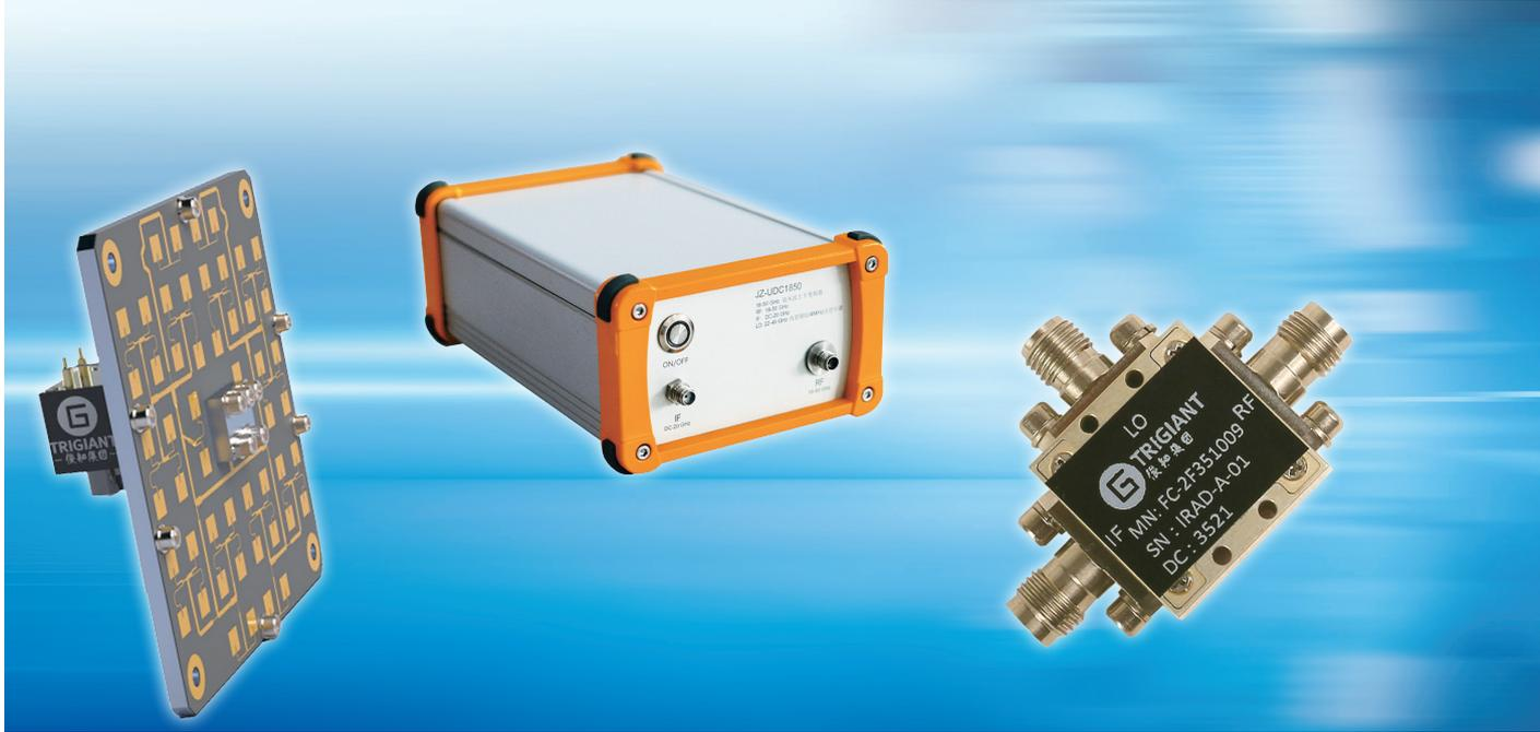
以上產品：(左) K 波段多普勒雷達頭, (中) 18 - 50 GHz 上下變頻器, (右) 18 - 50 GHz 平衡混頻器
