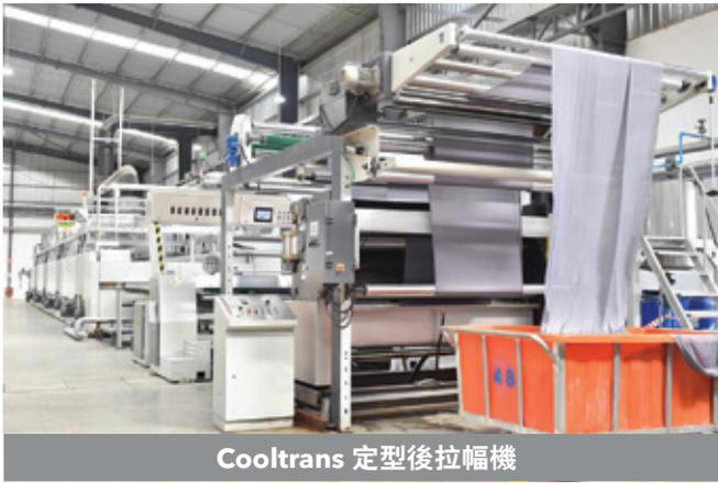
Cooltrans 定型後拉幅機
