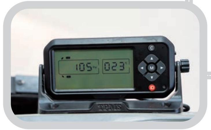
Ⓐ 九巴陸續於巴士車隊安裝胎壓監測系統，讓車長即時監測輪胎壓力和溫度，以提高巴士安全性
