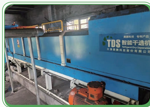
Picture: Intelligent dry separator used for clean production 圖：清潔生產使用的智能乾選機
