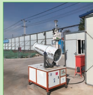
揚塵監控及除塵霧炮
