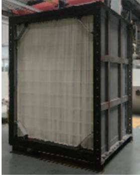
該產品的核心由改性高分子板製成，外殼由金屬製成，並有防腐蝕塗層。它多用於煙氣脫白工程。與金屬及玻璃等材料相比，改性高分子板式相變凝聚器結構緊湊，重量輕，耐硫磺及含氮化合物的酸性腐蝕。
