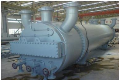
硫冷凝器形成一種特殊類型的換熱器的管殼式鍋爐。主要功能是冷卻換熱器系統上游反應段中產生的硫。
