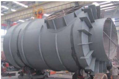
我們於二零一一年開發出一種低壓水封罐。與以前的水封罐相比，我們的產品流量大且具大型流動渠道，可將低壓氣相介質轉移的氣壓下降程度降低75%以上，節能效果良好。
