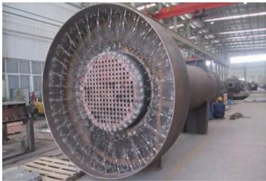
廢熱鍋爐是連接到硫回收設備使用的熱反應器的火管鍋爐。其主要用於通過產生中壓蒸汽來回收高熱量，並在此過程中將氣體冷卻。
