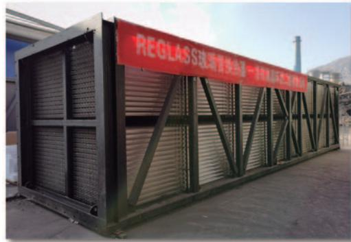
該產品的核心由玻璃管製成，外殼由金屬製成，並有防腐蝕塗層。它多用於煙氣脫白工程。與改性高分子材料相比，玻璃管換熱器具有更好的耐熱性和耐腐蝕性。
