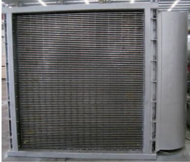
我們的金屬板式換熱器是專利產品，配合玻璃板式換熱器用於空氣預熱系統的高溫煙氣段。我們主要擁有兩個金屬板式換熱器的發明專利，即「一種弧形板式換熱器」（申請編號2014107685847）及「一種筒狀弧形換熱板式換熱裝置」（申請編號2014107677380）。「一種弧形板式換熱器」及「一種筒狀弧形換熱板式換熱裝置」的到期日分別為二零三四年十二月十四日及二零三四年十二月十四日。詳情請見本文件附錄五「法定及一般資料—有關本集團業務的其他資料—我們的重大知識產權」。
