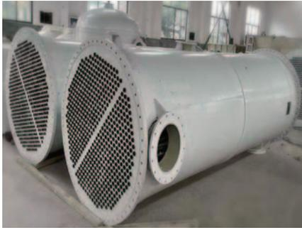
該產品的核心由改性高分子管製成，外殼由改性高分子材料製成。它多用於餘熱回收工程，亦可用於低溫腐蝕性液體環境。
