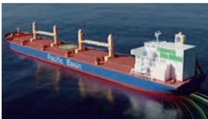
經過與日本合作夥伴Nihon Shipyard Co及三井物產兩年半的合作，太平洋航運已訂約四艘能夠使用綠色甲醇與傳統燃油的64,000載重噸超大型雙燃料新建造低排放乾散貨船。
